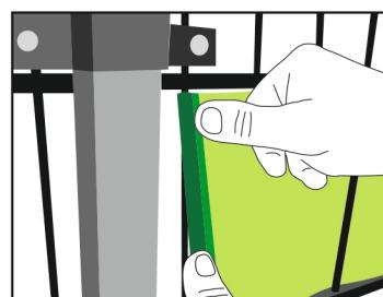
3. Монтажный клипс вместе с ограждительной лентой монтируем на панель.
